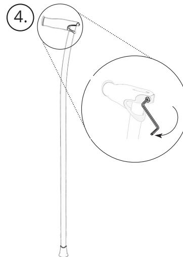
**ES-** Apriete el tornillo con la llave allen hasta que sienta resistencia. Luego dé otra media vuelta sin forzarlo. No exceda los 3 nm.
